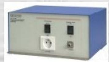
Compower 的所有 LISN 采用空芯线圈以防止饱和和渗透性变异。因此可长时间提供稳定表现。底部安装盘有一个未上漆的导电的表面, 这使得 LISN 在测试中可电子连接到地平面。每只 LISN 可单独校准验证正确阻抗值。
