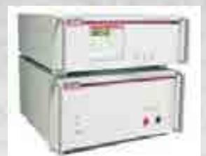
直流浪涌电压发生器：LSG-181CT 是按照 GJB181-86 进行设计，通过控制直流电源的正常、低压、高压和断电输出，模拟 GJB181-86 中所规定的用电设备耐电压浪涌试验，完成用电设备的欠压浪涌、过压浪涌、瞬时断电试验。
